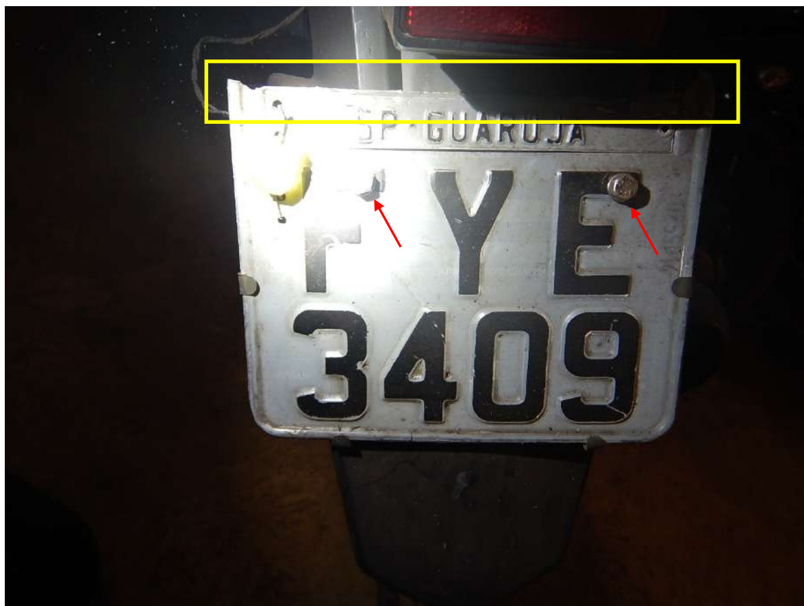
Fotografia 11 – Placa de licença com a parte superior cortada (retângulo em amarelo) e afixada na motocicleta com parafusos sobre a numeração (setas em vermelho).
