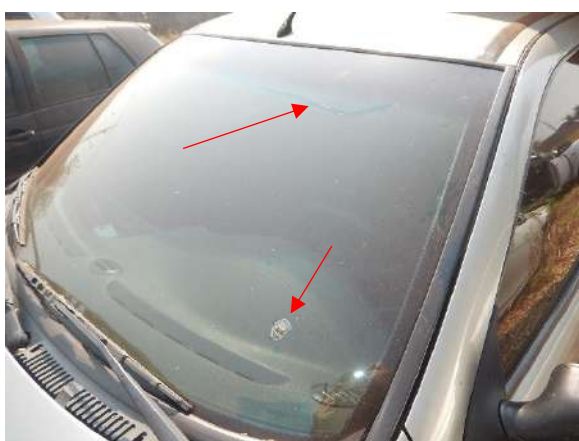
Fotografias 7 e 8 – Trincas no para-brisas.
